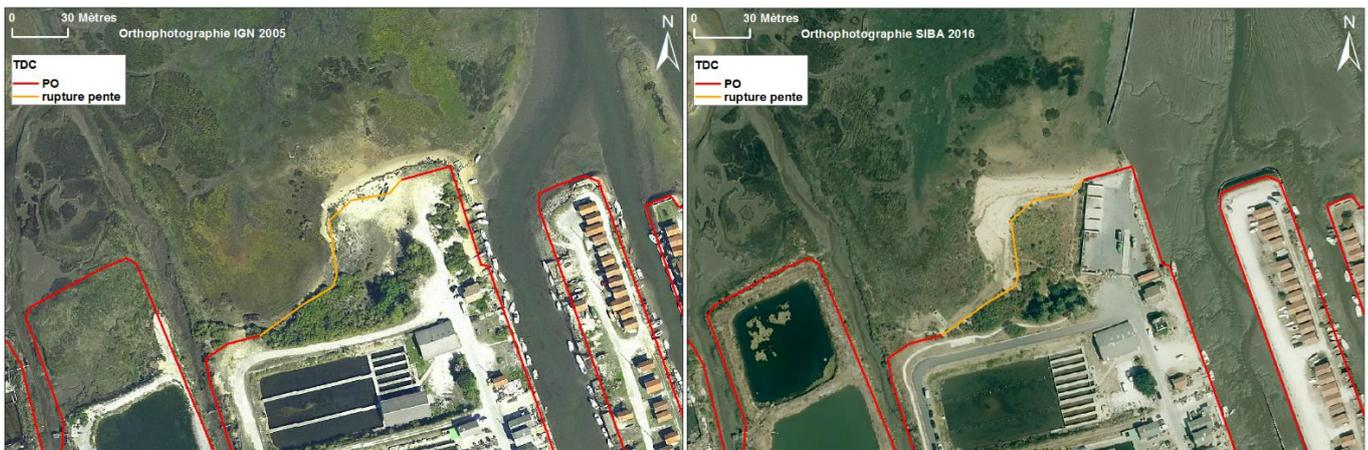
*Illustration 34 - Exemple d’estimation des  $T_x$  sur le Bassin d’Arcachon. Le trait de côte de 2016 est représenté sur chacune des 2 orthophotographies. En rouge, il correspond au pied des ouvrages (PO) et en orange à la rupture de pente topographique*
