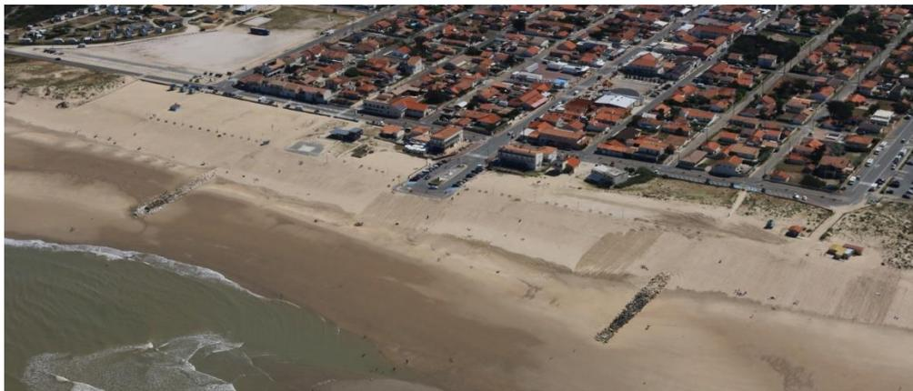
*Illustration 23 - Exemples d'ouvrage transversal : épis sur le front de mer de Montalivet (33)
