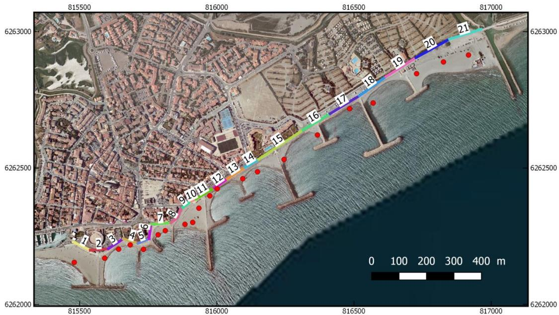
Figure 87 : Localisation des 21 segments pour le calcul des volumes franchissants. Les points rouges correspondent aux points d'extractions des conditions des vagues et de niveaux d'eau associés à chacun des tronçons.
