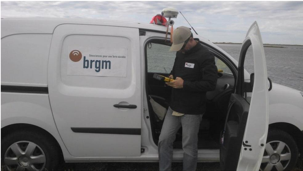
Figure 7 : Levé DGS RTK (Real Time Kinematics) le long de la digue à la mer (29 et 30 juillet 2015).
