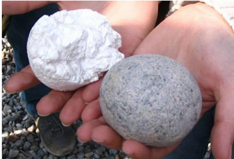
Figure 17 - Galets de silex, cru et après calcination (transformation de la calcédoine en cristobalite blanche, source Claire König, Futura Sciences).
