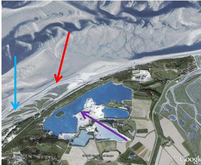
Figure 16 - Vue aérienne du site du Hourdel sur la commune de Cayeux-sur-Mer (source Google Earth, 2016) où sont exploités les galets de silice, à terre et sur l'estran, avec rechargement du tonnage extrait sur l'estran (en rouge) par un tonnage équivalent (en bleu).
