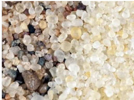
Figure 28 - Type de sable utilisé pour la fracturation hydraulique (source www.onyxpg.com ).
