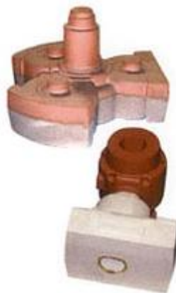
Figure 22 - Exemples de moules de fonderie en sables siliceux (source SACAB www.sablieres-du-bessin.fr ).
