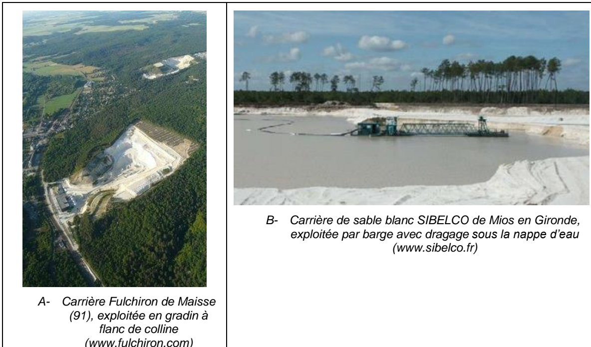
Figure 10 - Exemples de carrières exploitées en gradins et sous le niveau de la nappe.
