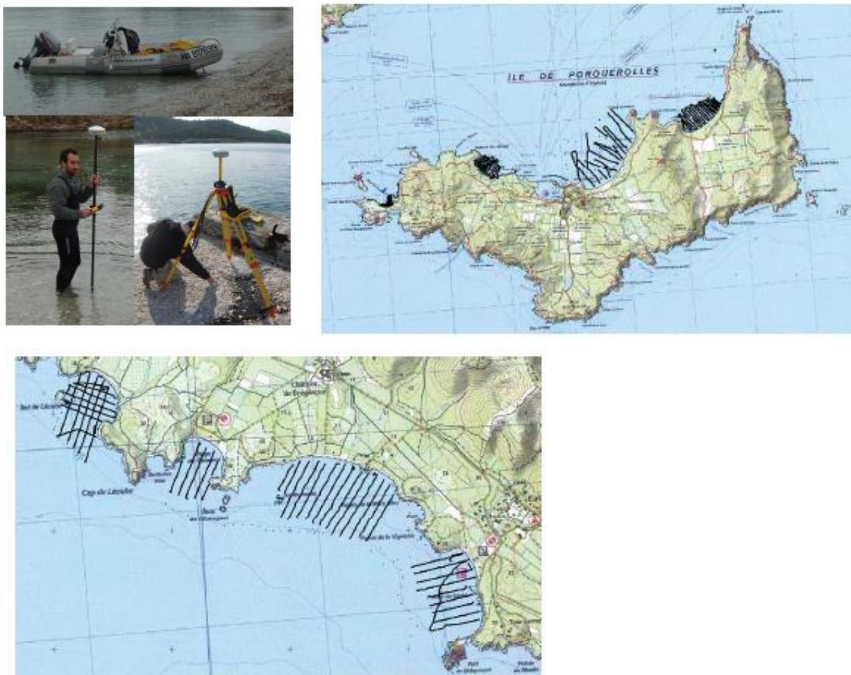
Illustration 24 - Levés topographiques par DGPS centimétrique et sondes bathymétriques acquises par le CEREGE dans le cadre de la Thèse de C. Brunel (2010).
