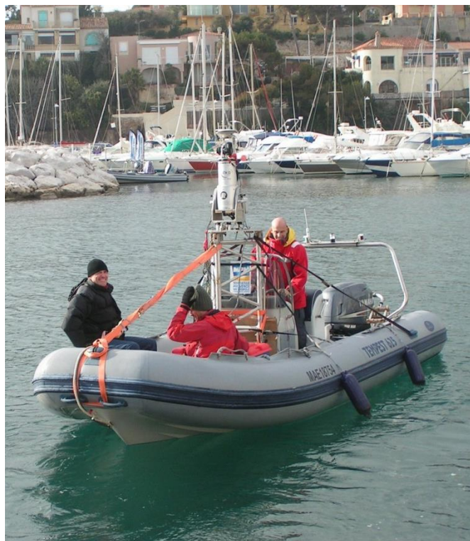
Illustration 16 - Installation du scan Laser sur bateau
