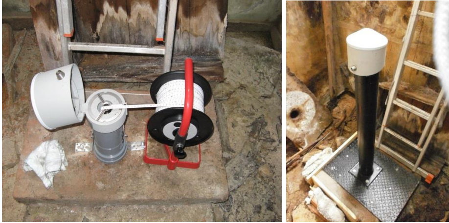
Illustration 37 : Photographies du piézomètre 01548X0010/S1 de Penchard (77) avant (à gauche) et après (à droite) aménagement du site.
