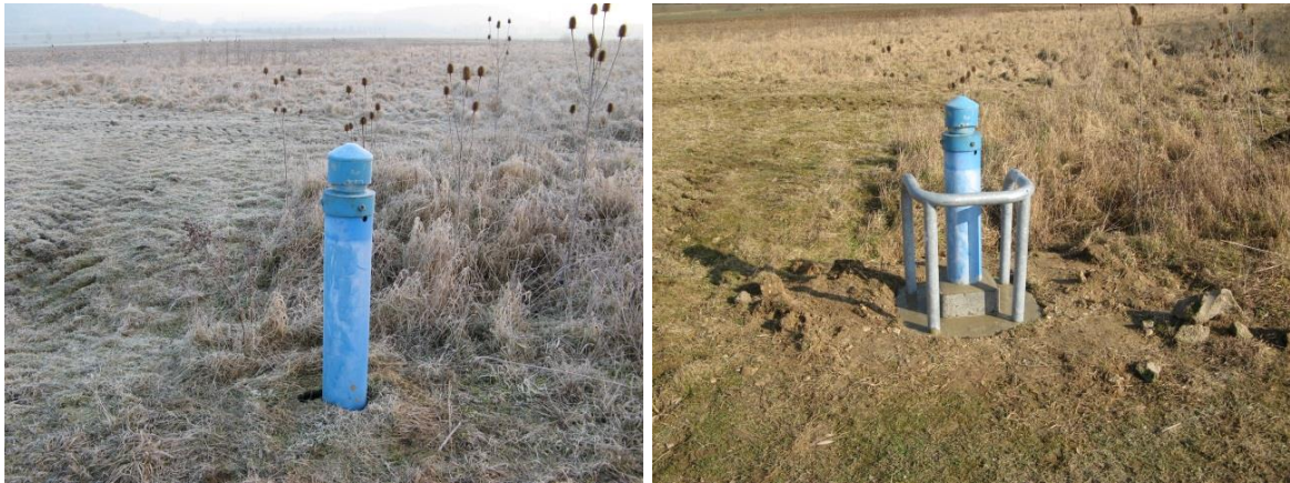
Illustration 31 : Photographies de l'aménagement du piézomètre 01067X0362/BL7 Bucy-Le-Long (02).
