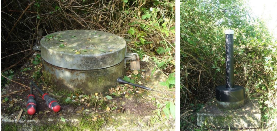
Illustration 40 : Photographies du piézomètre 02185X0159/P38 de Rambouillet (78) avant (à gauche) et après (à droite) aménagement du site.
