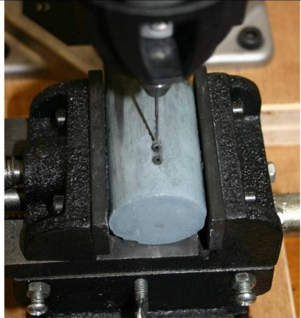
Dispositif de perçage des éprouvettes garantissant la verticalité et le parallélisme des deux petits trous afin de préserver les deux aiguilles de la sonde de mesure
