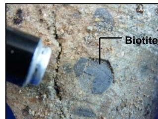
Illustration 6 : Photographies des blocs de dacite à amphiboles, quartz et biotites (3.7 à 6.2 m)
