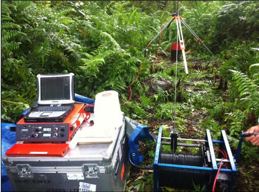
*Illustration 16 : Dispositif d'acquisition de la diagraphie électrique*
