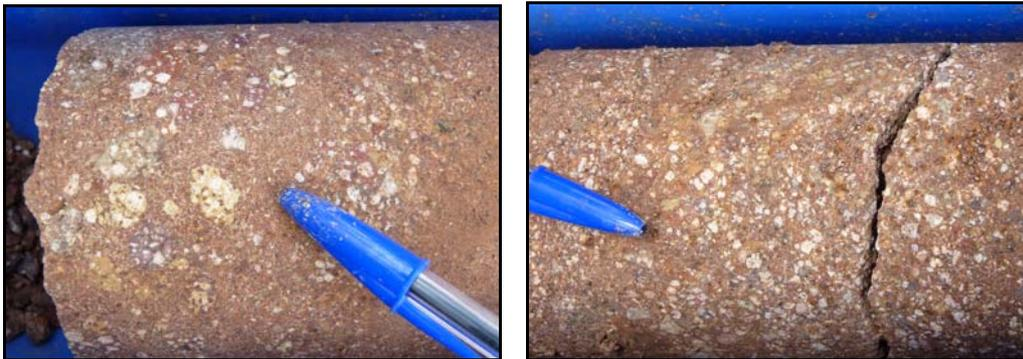
*Illustration 13 : Carottes d'une brèche prélevées à 36 m de profondeur (à gauche) et à 37 m (à droite)*
