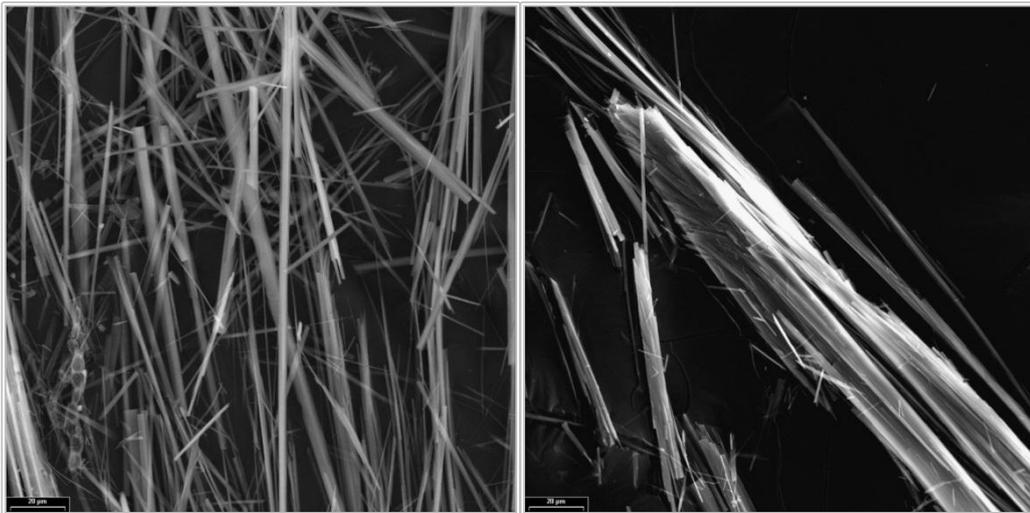
Illustration 100 : Images MEB des fibres d'actinolite-trémolite (échantillon 2BDL516-A).
