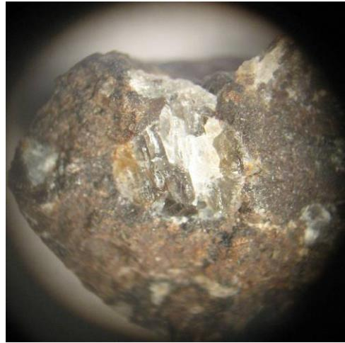
*Photo 14 : Agrégat blanc à jaunâtre, plagioclases altérés ou hyperstène ? (loupe binoculaire, grossissement x20)*
