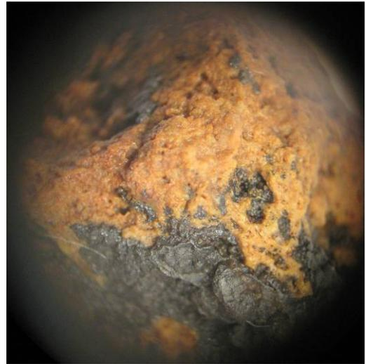
*Photo 21 : Couche d'oxydation (loupe binoculaire, grossissement x20)*
